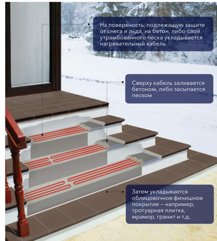
Вариант установки нагревательного кабеля для обогрева подъездных путей
