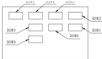
3. На печатной плате внутреннего блока имеется 2 поворотных переключателя и 6 микропереключателей, которые перед тестовым запуском должны быть установлены в соответствии с приведенными далее указаниями. Запрещается пускать систему, пока не будет завершена установки микропереключателей.
