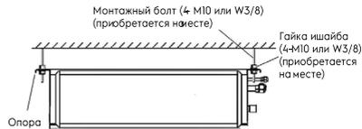
1. Порядок установки монтажного болта и гайки. Установите гайки на четыре болта, как показано на рис.
