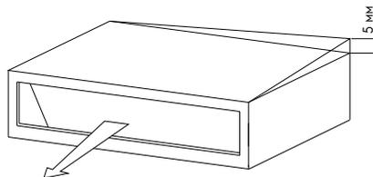
2. Для улучшения дренажа задняя часть внутреннего блока расположена несколько ниже передней части (на 0-5 мм), как показано на рис.
