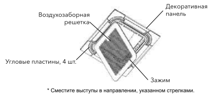
Снятие воздухозаборной решетки
